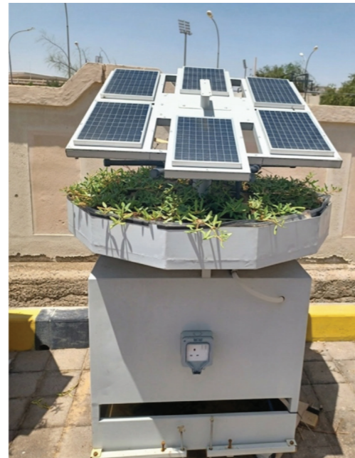
الشكل 2: صورة للنموذج الأولي الفعلي للنظام مع نباتات تنمو تحت مظلة الألواح الشمسية
